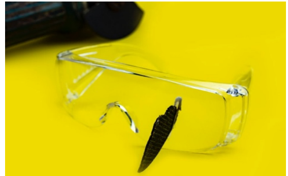
Resultado de la Explosión de un Disco de Corte
